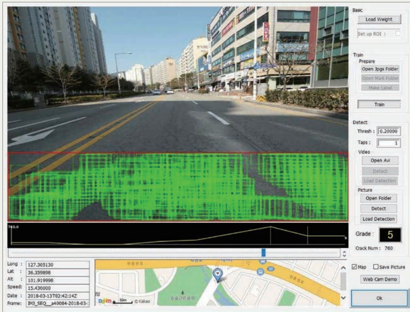
[그림 7] 균열 검출 소프트웨어 인터페이스(예시)
