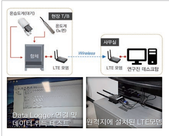
[그림 7] 계측데이터 취득 프로세스 및 설치 전경
