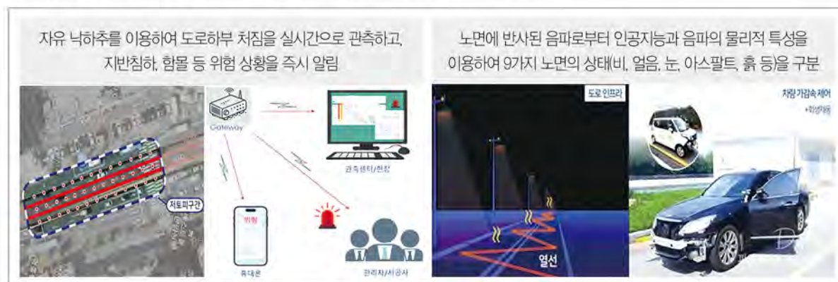
[그림 2] 최신 IoT 기반 도로 위험 실시간 탐지 및 관리시스템: (좌) 지반침하, (우) 도로결빙
