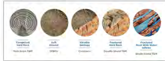
[그림 3] 암반의 특성에 따른 TBM
