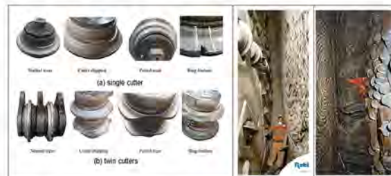
[그림 4] 극경암에서의 TBM 굴진 시 문제
