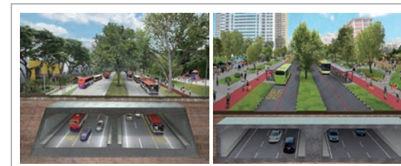
[그림 27] NSC 지하고속도로 설계 - 개착공법
