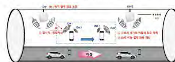
〈그림 7〉 블루투스, UWB 위성측위 신호생성 시스템 구조
