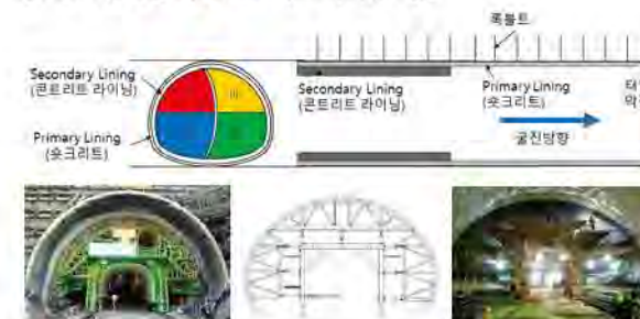
[그림 26] 현장 타설 콘크리트 라이닝 시공
