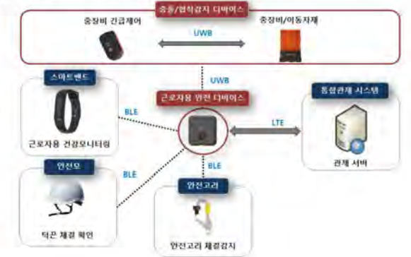
〈그림 5〉 스마트 안전장비 구성 및 연계도
