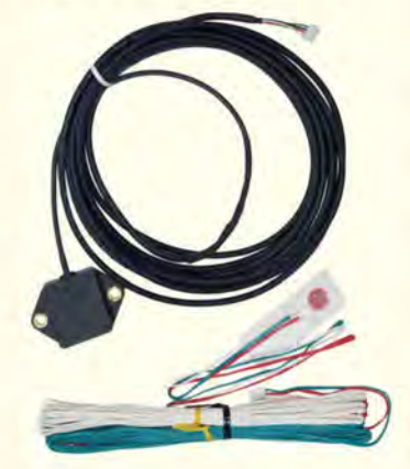
〈그림 9〉 설치센서(경사계, 변형률계)
