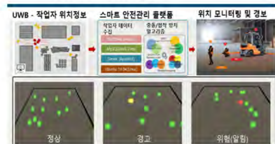
〈그림 10〉 건설현장 중장비 운전자/근로자 인적 오류에 의한 충돌 및 협착사고 예방 시나리오
