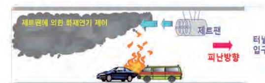
〈그림 5〉 종류식 제연방식의 제트팬에 의한 화재연기 제어
