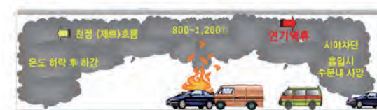
〈그림 5〉 종류식 제연방식의 제트팬에 의한 화재연기 제어
