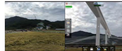
〈그림 7〉 AR을 활용한 시공 전 현장 확인(토목현장)
