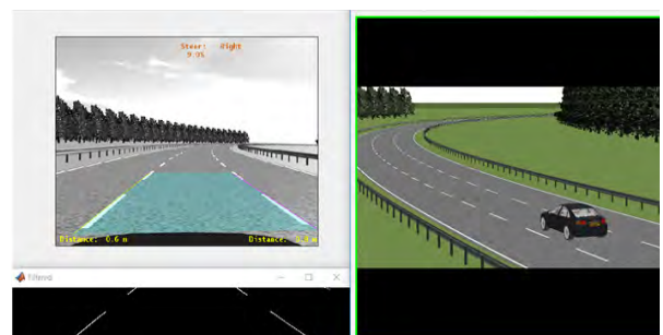
〈그림 9〉 차로유지보조시스템 구현 예시
