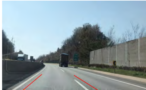
〈그림 2〉 기하구조에 의한 (오른쪽)쏠림 예시
