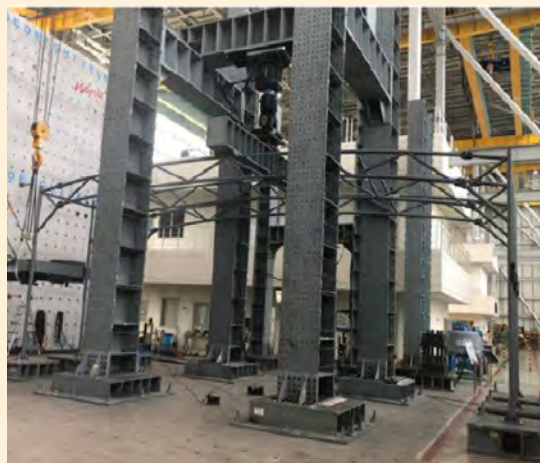
<그림 3> 차선폭 12M 실물스케일 방음터널 시험체
