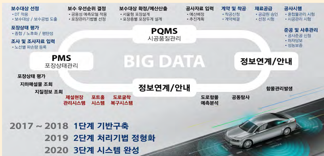
<그림 4> 빅데이터 시스템을 통한 도로포장 통합 관리
