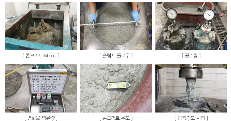
<그림 2> 초고강도 콘크리트 실내배합 시험
