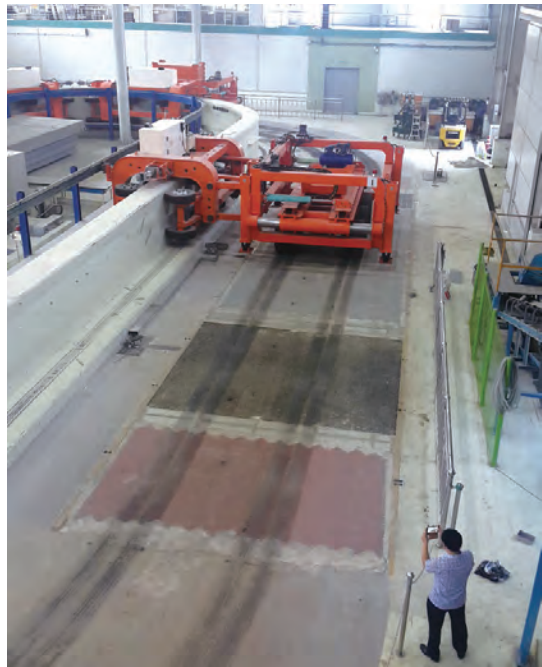
APT(Accelerated Pavement Tester) 포장가속시험기_짧은 기간 동안 과학적 방법에 따라 포장(수명)을 평가하기 위해 사용됨 (한국도로공사 도로교통연구원)
