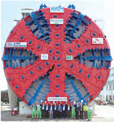
〈그림 4〉 유라시아터널 슬러리 TBM(직경 13.7m)
