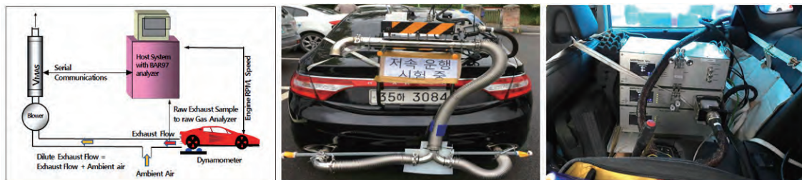
〈그림 6〉 터널 환기설계 최적화를 위한 차량 배기가스 측정
