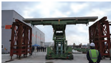
슬래브 이동 및 거치 장비
