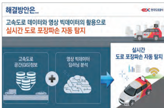
〈그림 3〉 실시간 도로 포장 파손 탐지 개념도
