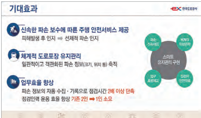
〈그림 10〉 도로 포장 파손 탐지 시스템 기대효과
