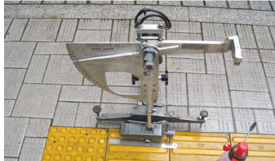
〈그림 16〉 시각장애인 점자블록 BPT 시험
