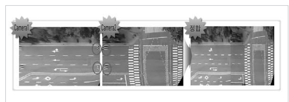
〈그림 5〉 Maker point를 이용한 특징점 추출 및 영상 정합 방법
