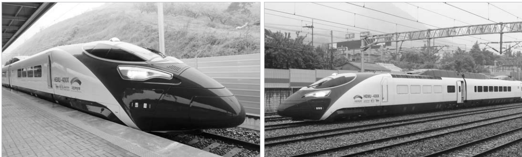
〈그림 2〉 동력분산형 430km/h급 차세대 고속열차
