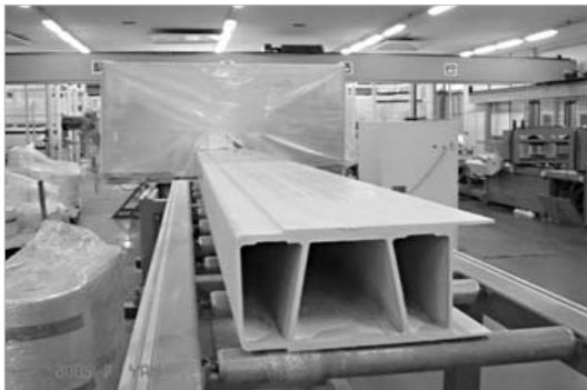
〈그림 2〉 복합소재 교량 바닥판의 인발성형 튜브 제조
