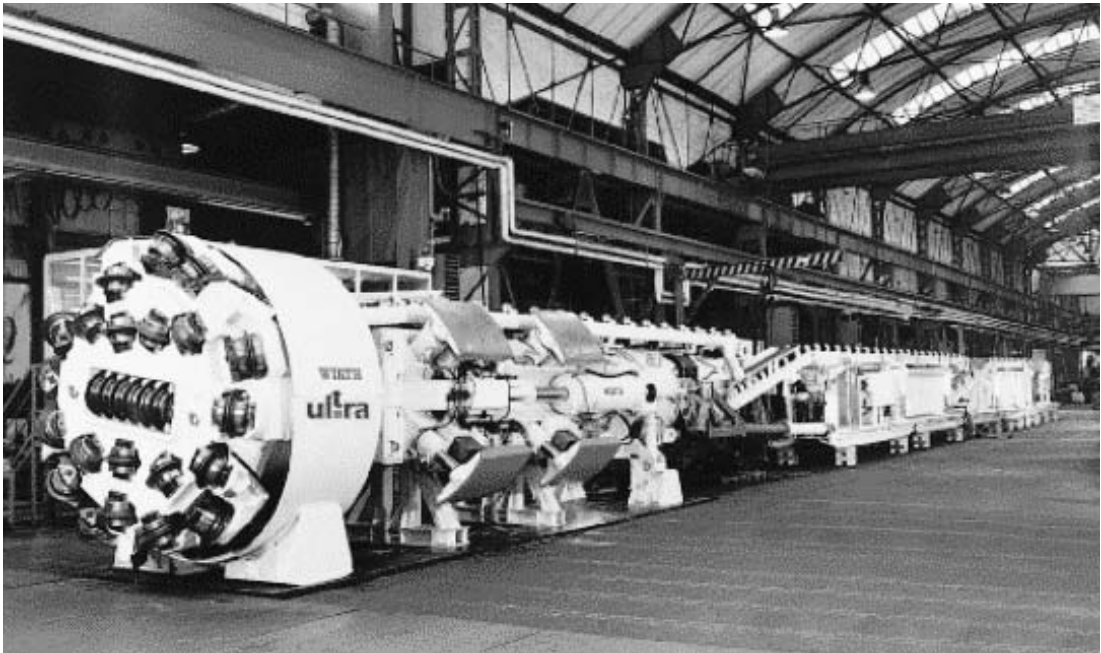
국내 유일 암반용 OPEN TBM 장비
