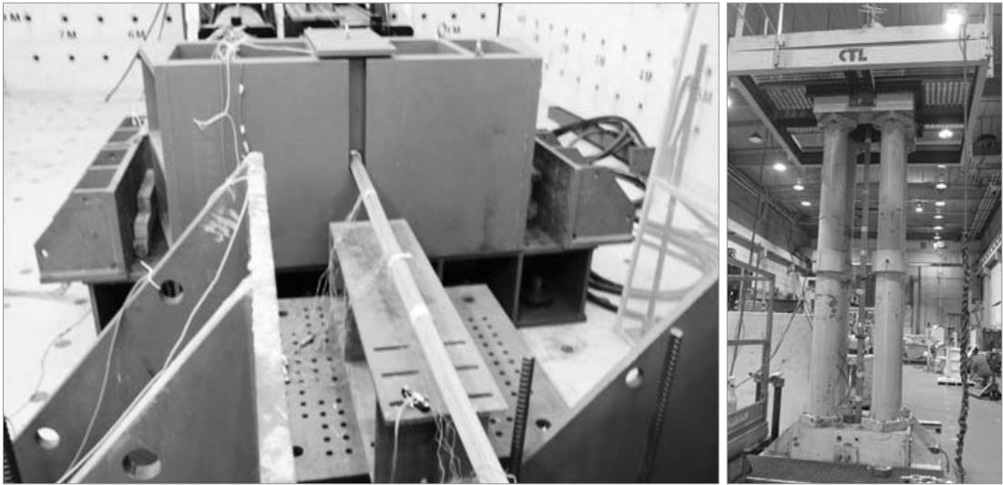
〈그림 4〉 평행선 케이블의 국내외 품질 인증 시험
