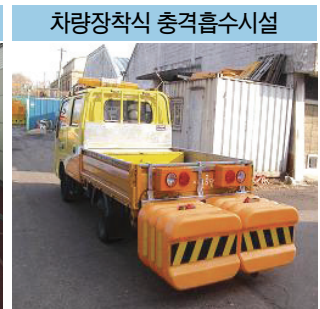
차량장착식 충격흡수시설 싸인카 및 도로상 작업차량 후면 부착 → 도로작업 안전 증대
