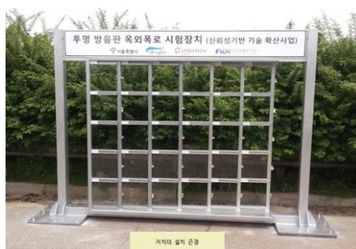
투명방음판 성능개선을 위한 옥외폭로시험장치 설치
