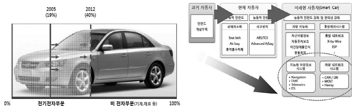
〈그림2〉 차량 내 전장부품 비중의 증가 및 자동차의 진화
