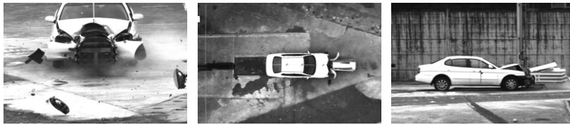
〈그림 11〉 충격흡수시설의 충돌시험(TC1.2.80) 장면
