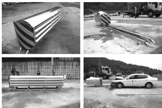
〈그림 9〉 충돌시험 전 · 후 시설물(TC1.2.80)
