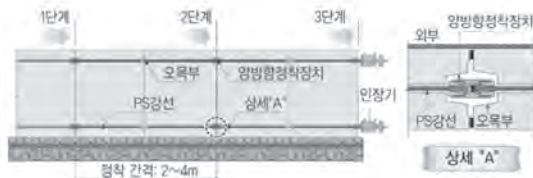
〈그림 3〉 양방향 강선 정착장치를 이용한 긴장재의 연속화
