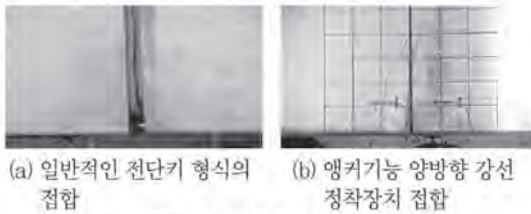
〈그림 10〉 접합부 파괴 모습
