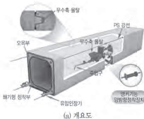
〈그림 5〉 개발된 연결시스템을 적용한 프리캐스트 콘크리트 박스암거
