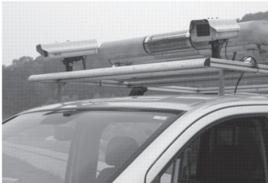
그림2. 도로환경 자료수집용 CCTV (좌) 및 레이저/가속도센서 장치 (우)
