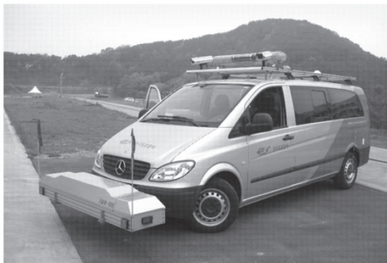
그림1. 기하구조 측정차량 외관 (좌)과 차량 내에 탑재된 자료 수집 시스템 (우)
