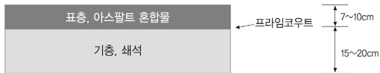
〈그림 5-1〉 아스팔트 콘크리트 포장 구성
