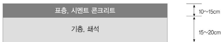
〈그림 5-2〉 시멘트 콘크리트 포장 구성
